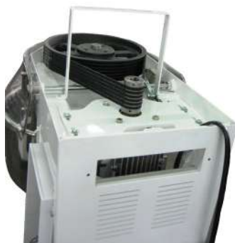
1 Прочность: передача мощности ремнем не требует обслуживания
